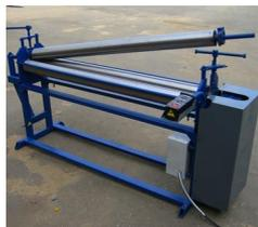
Работа всего механизма зависит от хорошей подгонки деталей друг к другу. Выбирать валки нужно внимательно, их низкое качество приводит к браку производства. Обычно используют чугун в качестве материала, но и стальные тоже не редкость. Новейшие разработки - ролики из твердых керамических сплавов, имеющие большой срок службы.
